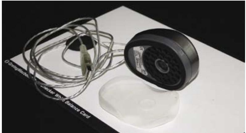
Рис. 4. iOne Display компании GretagMacbeth с насадкой для измерения освещенности
