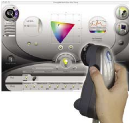
Рис. 3. EyeOne Pro компании GretagMacbeth с насадкой для измерения освещенности
