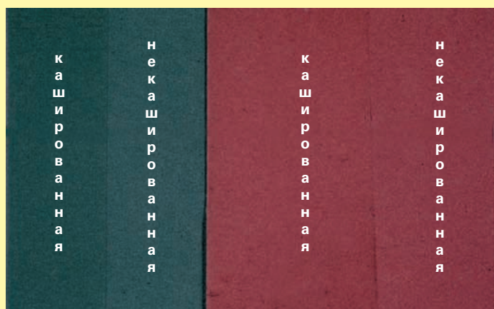
Рис. 2. Оттиски разных цветовых тонов до и после каширования.
