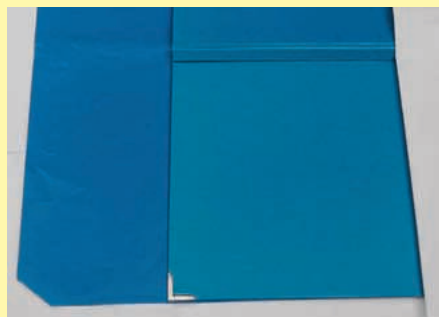
Рис. 1. После вставки блока в переплетную крышку цвет последней заметно изменился.
