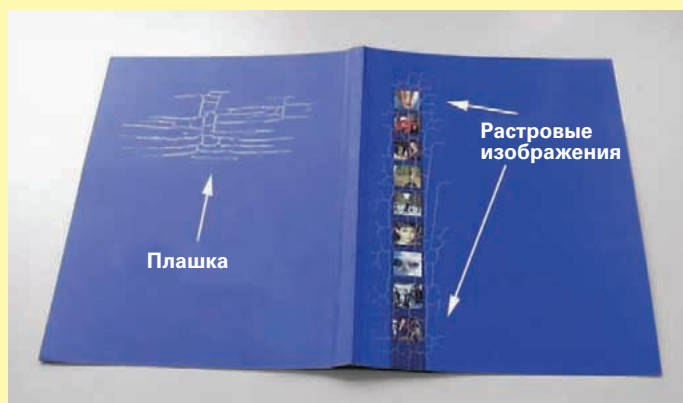
Рис. 5. Образование складок на пленке после каширования книжной обложки.
